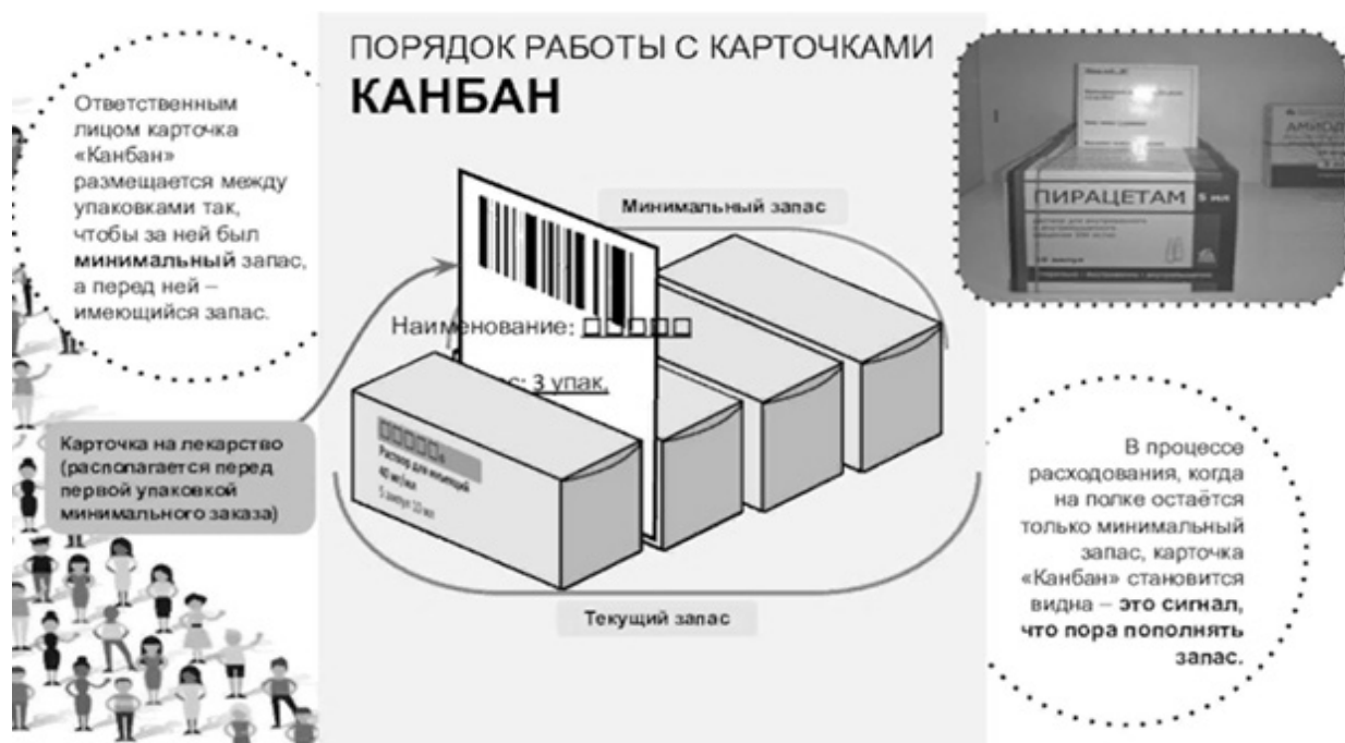
Рис. Порядок расположения и работы с карточками в системе «Канбан»
